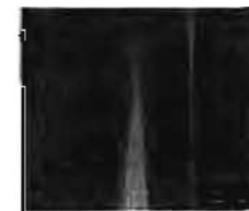
Кончик иглы кантилевера. Радиус скругления острия < 10 нм (на пределе разрешения растрового электронного микроскопа)
