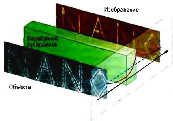
Рис. 4.3. Принцип действия микроскопа на суперлинзах
