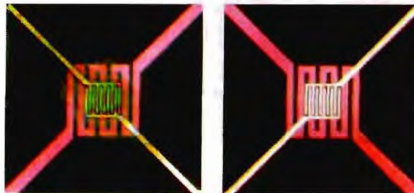
Рис. 3.24. Фотографии двух наносенсоров, изготовленных исследователями из NIST. Каждое устройство 100 мкм в длину. Слева микронагреватель покрыт проводящим полимером — полианилином (зеленого цвета), а справа — такой же нагреватель без покрытия
