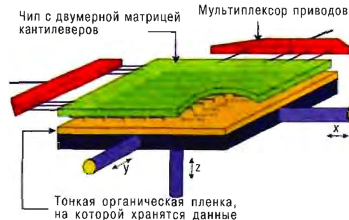
Рис. 3.7. Принцип действия «Многоножки»
