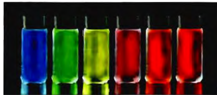
Рис. 4.7. Изменение ширины запрещенного энергетического слоя приводит к возникновению квантовых точек разного цвета
