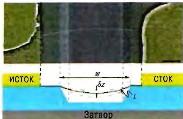
Рис. 3.17. Геометрия устройства и диаграмма расположения нанотрубки на электродах. Масштабная метка – 300 нм
